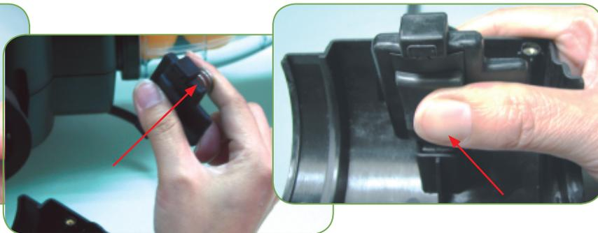
ステップ 12：右側ボールハウジング（内部）のカバーを閉め本体ヘッド部分がスムーズに動くか確かめます。（左右のハウジングを閉める時、滑走板はスロット内部に納めます。）確認できたらカバーのネジを4個締めます。（注：左右のボールハウジングを閉じた後、滑走板が正しく配置されているか押して確かめましょう。もし押しても弾力が無ければ正しく配置されていないので再度やり直しましょう。）
