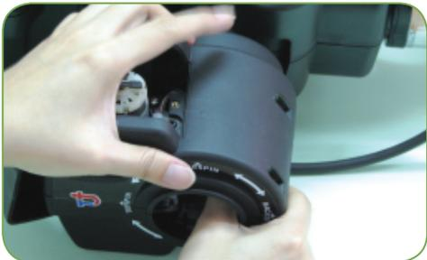
ステップ 6：ボールサービス車輪のネジを緩めます。(この専用ネジは時計回りに緩める事が可能です。)
