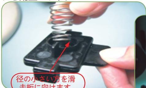
ステップ 11-2：滑走板及びスプリングを親指を使って押しながら握り左スロット部分のサービスハウジング（内部）に配置します。方向に注意してください。誤って反対方向へ取り付けてしまうとセンサースイッチが動かなくなりボールの打ち出しに必要な出力が得られなくなります。
