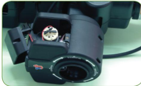
ステップ 5：頭部格納庫の左右のカバーを開きます。滑走板及びスプリングが飛び出さないように滑走板を親指等で予め押さえておくと良いでしょう。
