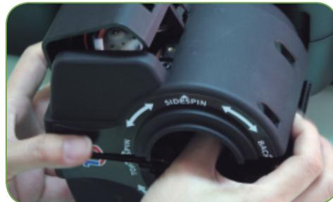
ステップ 13：右側ボールハウジングのネジ4個を締め、新しいDCモーターを設置し、ワイヤーを取り付けましょう。
