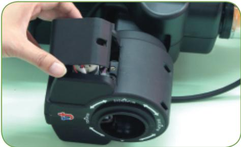
ステップ 4：機体右側の格納部にある止めネジ 4 個を緩めます。
